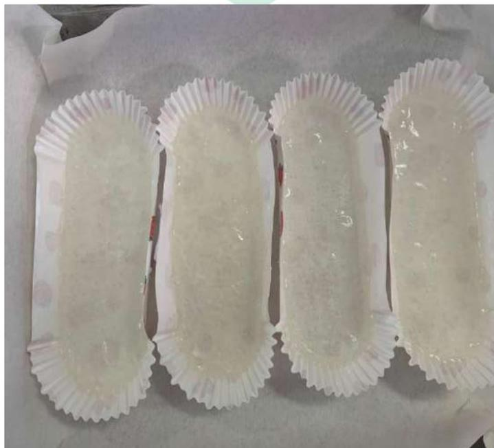
Gambar 8. Massa *Edible film* Dituang Dalam Cetakan
