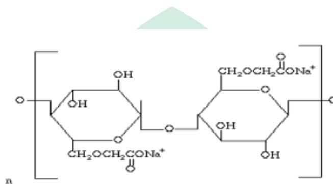
Gambar 2. Rumus Struktur Natrium Karboksi- metilselulosa
