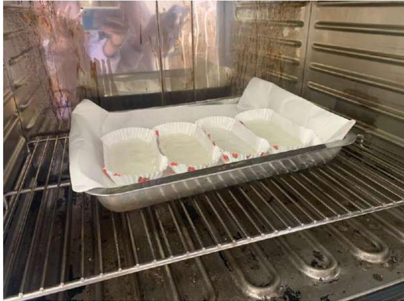
Gambar 9. Pengeringan Didalam Oven Suhu 50°C
